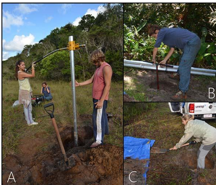
Figura 4: Tipos de amostragens sedimentológicas: vibrotestemunhagem (A); trado (B) e escavação de trincheiras (C). Fotos: Buchmann.
