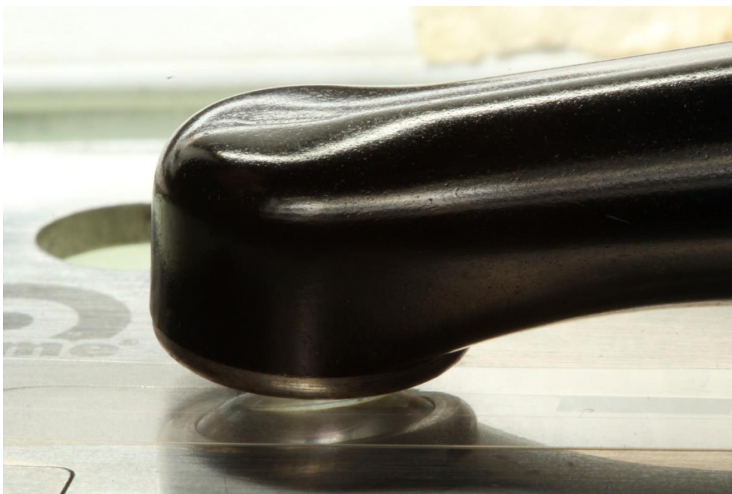
Fig 4 – O fotopolimerizador foi posicionado sobre a abertura coberta pela tira de poliéster e ligado no modo standard ( 1000 \text{ mW/cm}^2 ) por 20s em cada lado.
