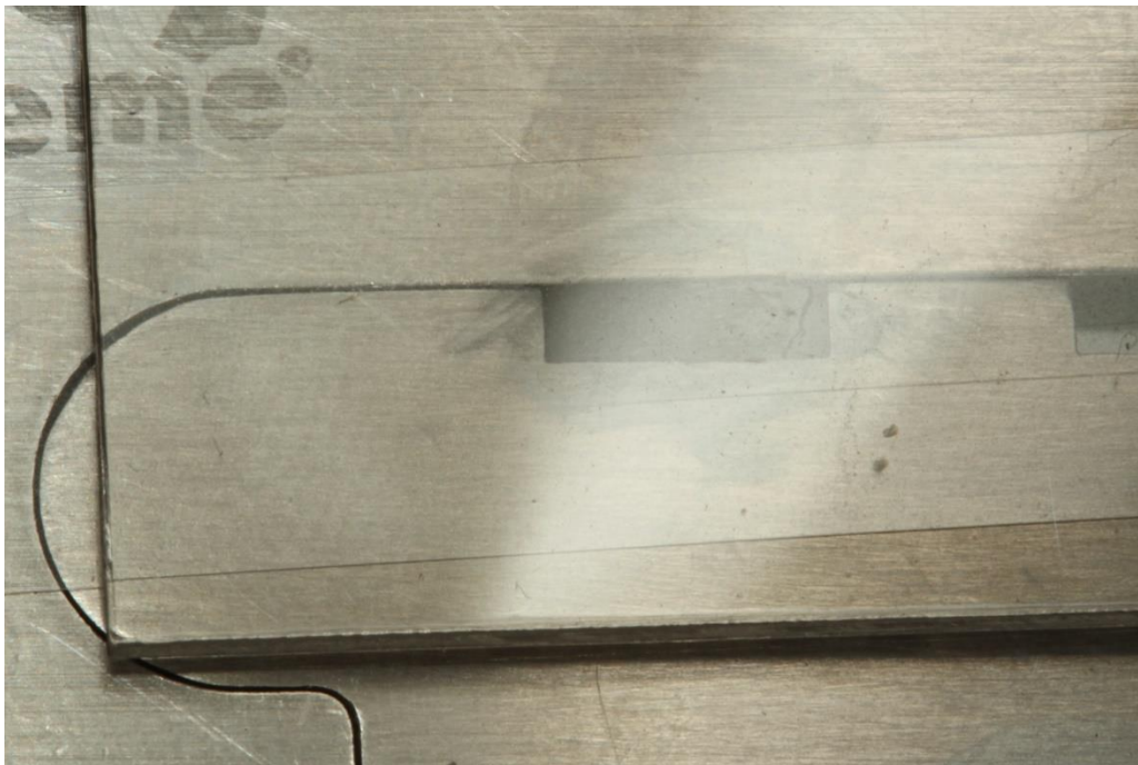
Fig 3 – Após a inserção e remoção do excesso de material, uma tira de poliéster é posicionada sobre a abertura superior da matriz e sobreposta por uma lâmina de vidro que é pressionada levemente sobre o conjunto.
