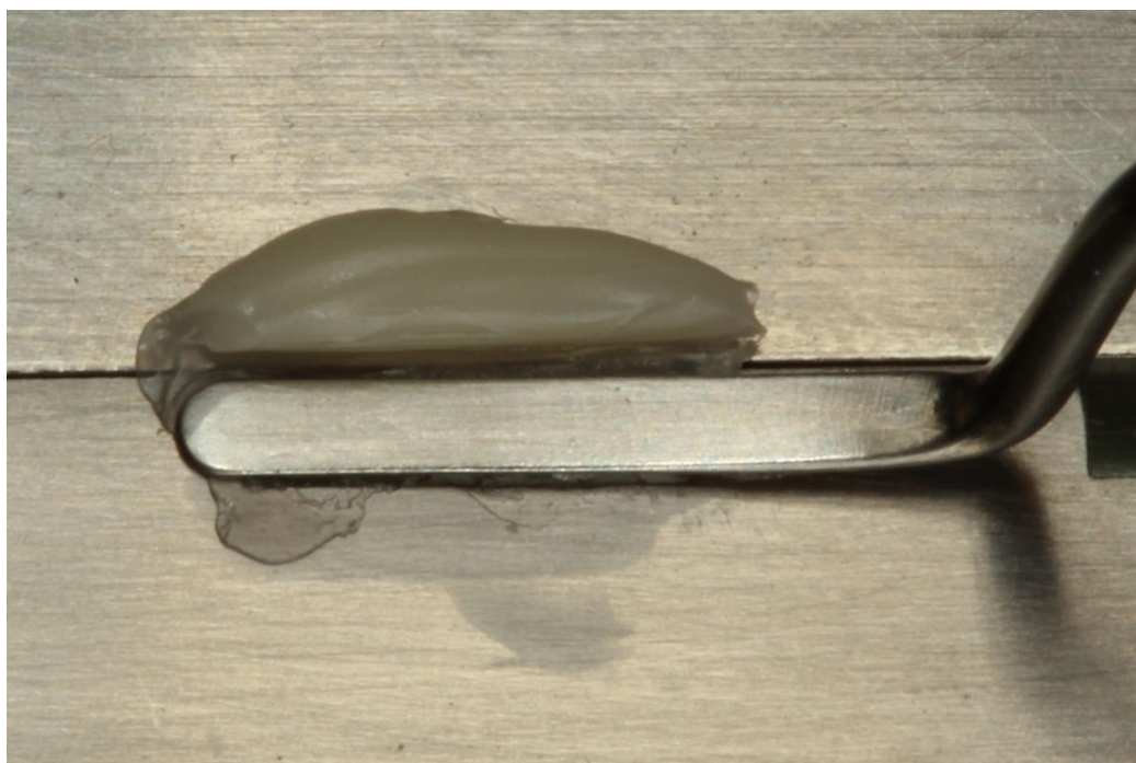
Fig 2 – Detalhe da inserção do material em incremento único.
