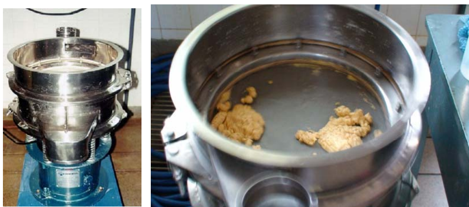
Figura 11: Peneira vibratória e fibra recuperada.
