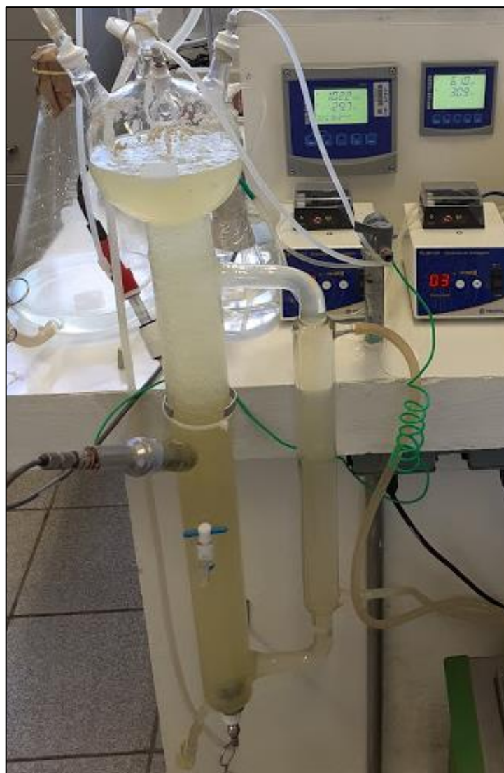
Figura 34 – Produção de \gamma -PGA em biorreator airlift , sistema em funcionamento com coloração amarelo claro, sem formação excessiva de espuma
