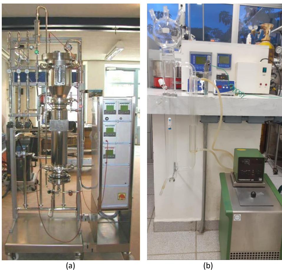
Figura 8 – Biorreator airlift de bancada: circulação interna (a) e externa (b)
