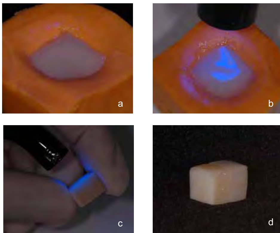
FIGURA 9- Seqüência de confecção do conjunto cerâmica - cimento resinoso: a) cimento resinoso sobre a superfície cerâmica; b) fotopolimerização da superfície exposta do cimento; c) fotopolimerização das faces do conjunto cerâmica - cimento resinoso; d) conjunto cerâmica - cimento resinoso.
