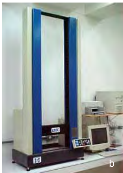
FIGURA 12 a- cp fixado no paquímetro; b- máquina de ensaio universal – EMIC.
