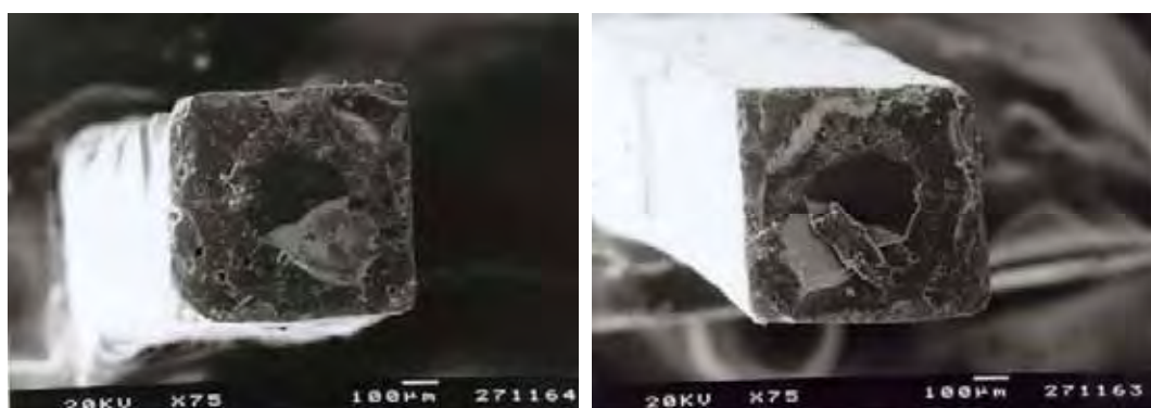
FIGURA 17- Micrografias representativas de uma fratura (amostra do Grupo 4) após o ensaio de microtração (MEV – 75x), sugestivo de degradação.
