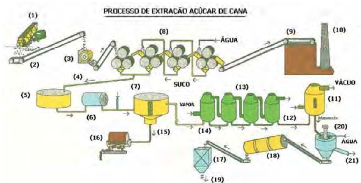
Figura 7: Processo para produção açúcar a partir da cana-de-açúcar 38 : (1)-Recebimento da Cana; (2)-Transportador; (3)-Triturador; (4)-Caldo de Cana; (5)-Tanque de Decantação; (6)-Aquecimento; (7)-Clarificação; (8)-Moagem da Cana; (9)-Bagaço; (10)-Caldeira; (11)-Tacho a Vácuo; (12)-Caldo Purificado; (13)-Evaporador a Vácuo; (14)-Caldo Clarificado; (15)-Caldo Turvo Descartado; (16)-Filtragem; (17)-Açúcar Pó Seco; (18)-Secador Spray Dryer; (19)-Enviado para Silos de Estoque; (20)-Melaço; (21)-Melaço.
