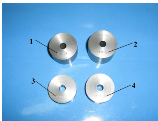
Figura 16 – Anilhas de carga utilizadas no ensaio de desgaste (1 – 250 g; 2 – 300 g; 3 – 100 g; 4 – 150 g).
