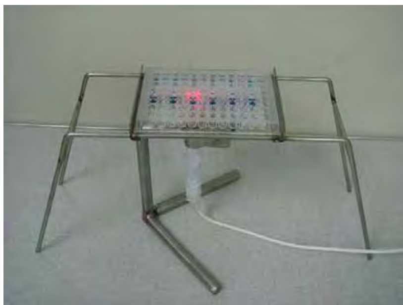
Figura 2 - Suporte para realização da terapia fotodinâmica in vitro
