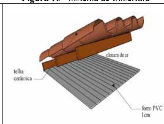
Figura 16 - Sistema de Cobertura
