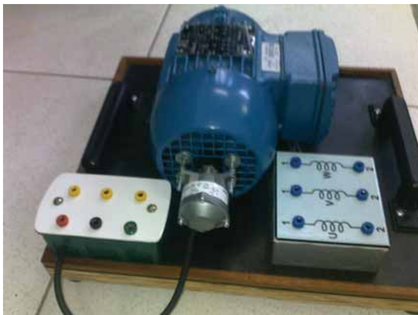
Figura 28: Caixa de ligação do encoder.
