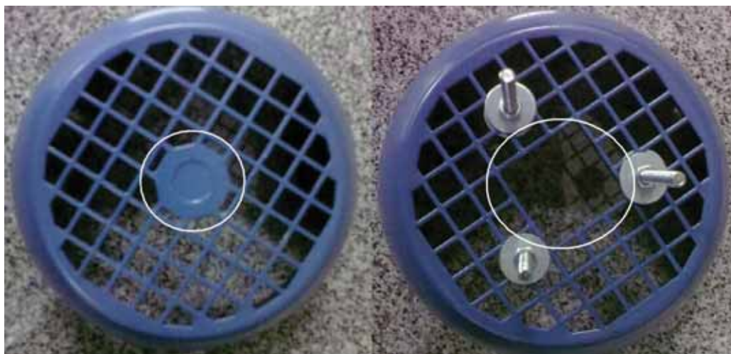
Figura 25: Corte da tampa traseira do motor.
