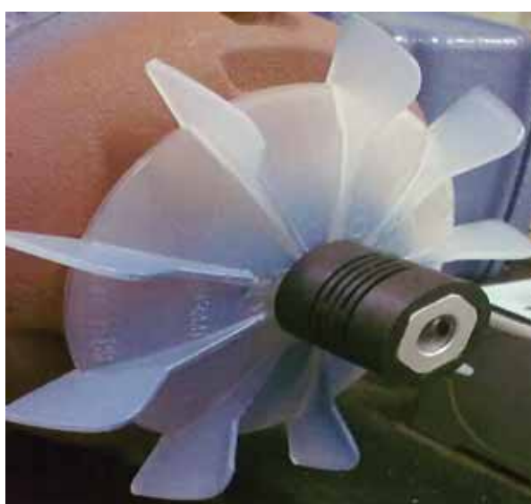
Figura 24: Ventoinha possibilitando o encaixe do acoplamento.
