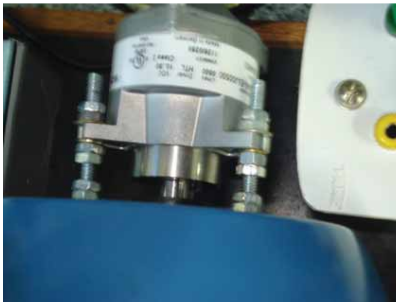
Figura 27: Encoder acoplado ao motor.
