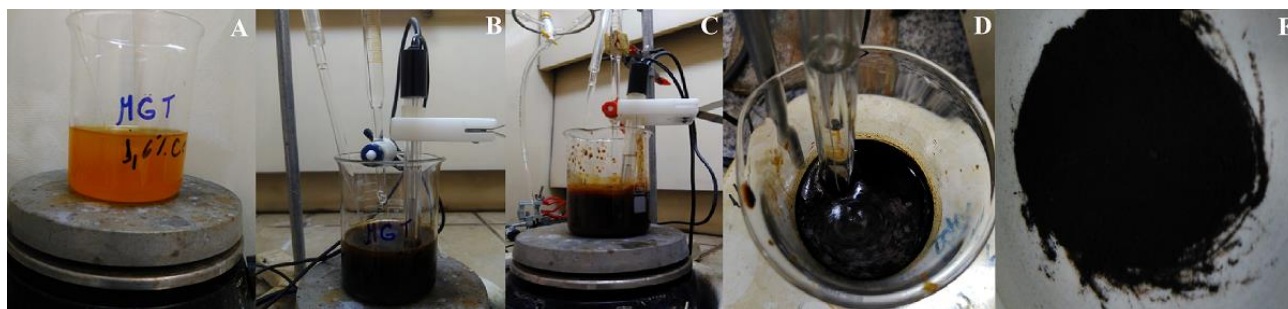
Figura 5. Etapas da síntese dos materiais. A – solução de ferro e cério; B – solução com a adição de base; C – suspensão durante agitação magnética; D – suspensão obtida ao final da síntese; E - material seco obtido ao final da etapa de tratamento térmico.
