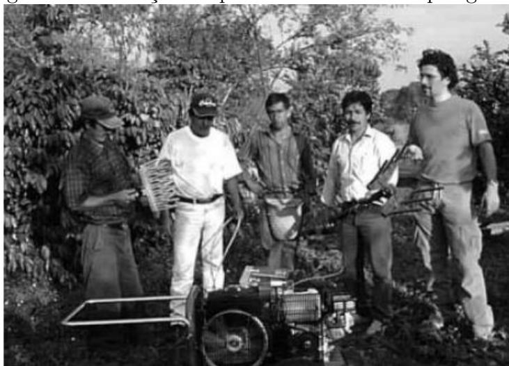
Figura 2.3: Derrigadora pneumática acionada por gerador
