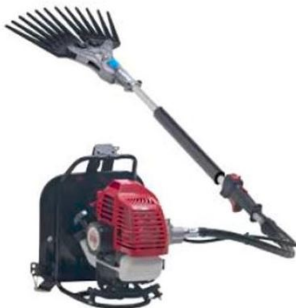
Figura 2.5: Derriçadora à combustão para colheita de café
