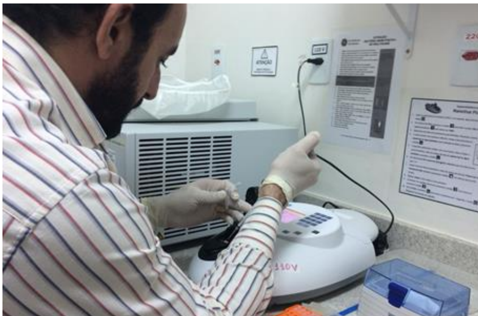
Figura 5. Concentração de DNA presente em cada amostra e respectiva quantificação em espectrofotômetro (NanoVue Plus®). Botucatu, SP, 2019. Fonte: arquivo pessoal.
