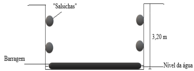
Figura 30: Corte transversal das intervenções no R3.
