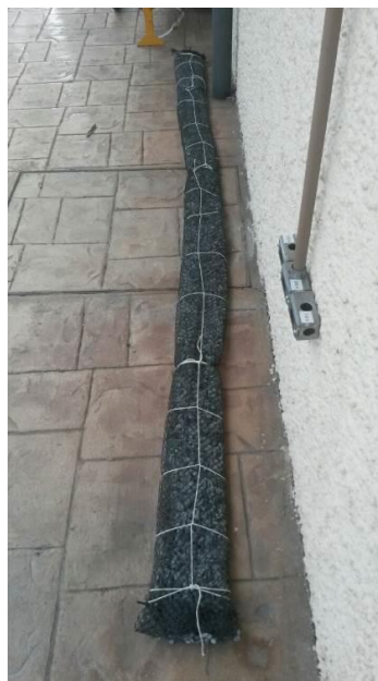
Figura 32: Composto geotécnico (mini-barragem) confeccionada e pronta para instalação.
