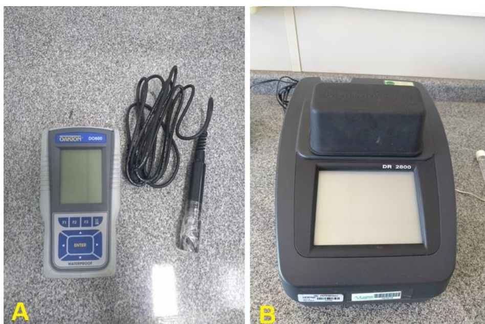
Figura 17: A- Para leitura do O.D utilizou-se o equipamento da marca OAKTON, modelo DO 600. B- O espectrofotômetro utilizado para leitura do \text{PO}_4^{3-} foi da marca HACH Company, modelo DR 2800 Fonte: O autor (2019).
