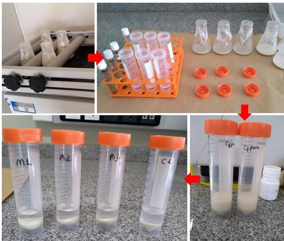
Figura 12: Sequência de etapas para análise da remoção de fosfato, na sequência: amostras em agitação, tubos para transferência da amostra, amostras preparadas para centrifugação e amostras após etapa de centrifugação (solução e argilas já separadas). Fonte: O autor (2018).
