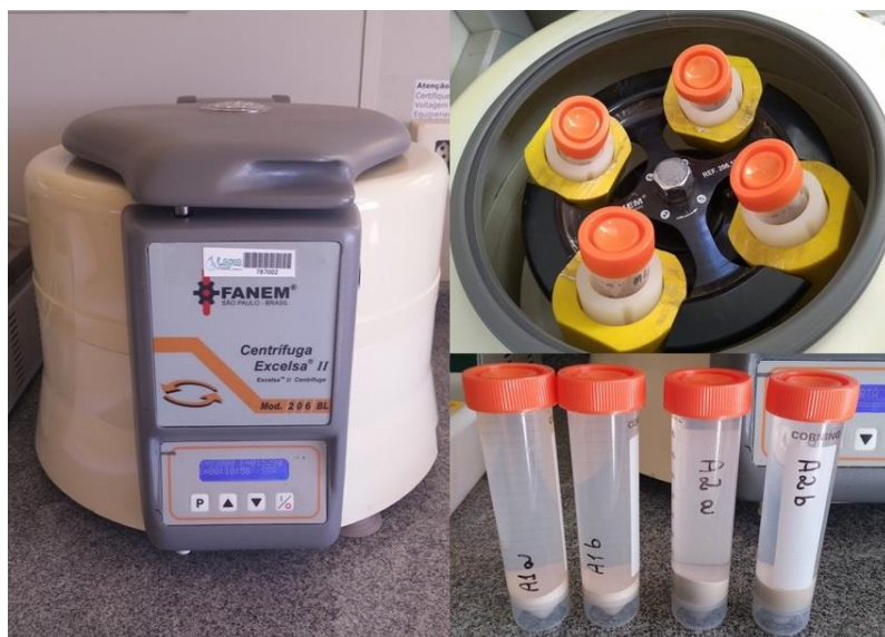
Figura 10: Centrífuga utilizada nas etapas de laboratório, amostras posicionadas na centrífuga e após o processo de centrifugação (fica evidente a separação entre o líquido e a argila). Fonte: O autor (2018).
