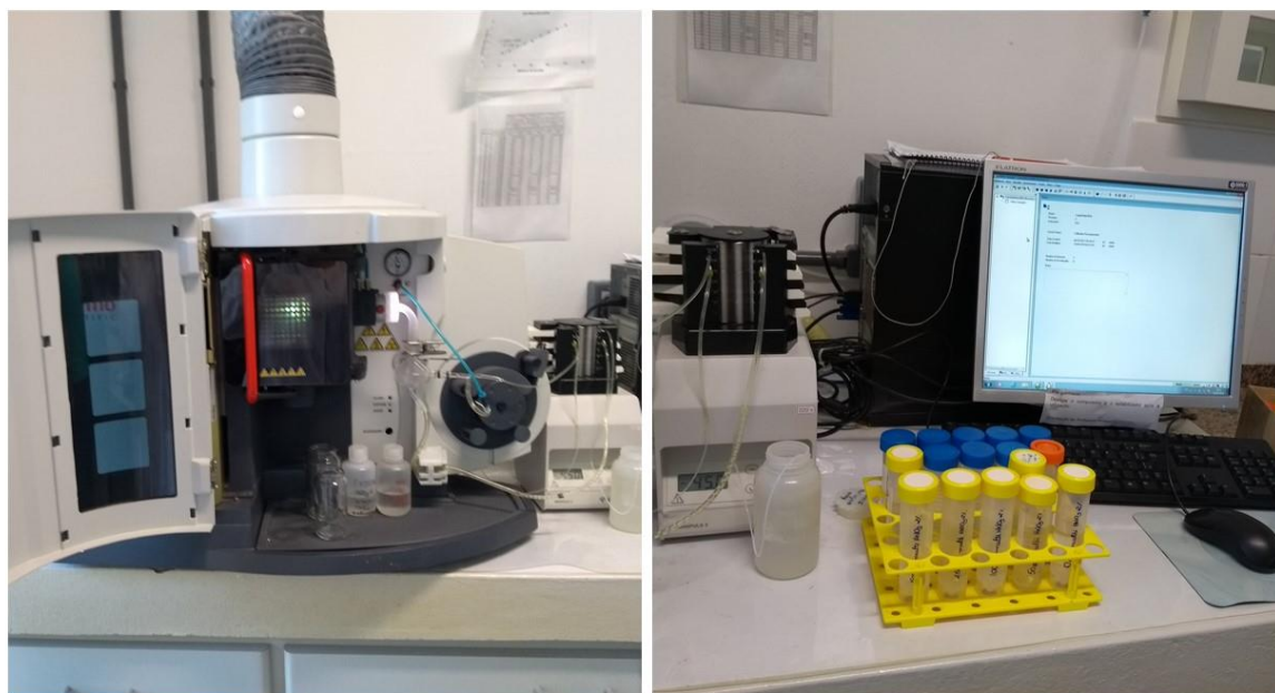
Figura 11: Equipamento Thermo ICAP – 6000, utilizada para quantificação de Pb nas amostras. Fonte: O autor (2017).
