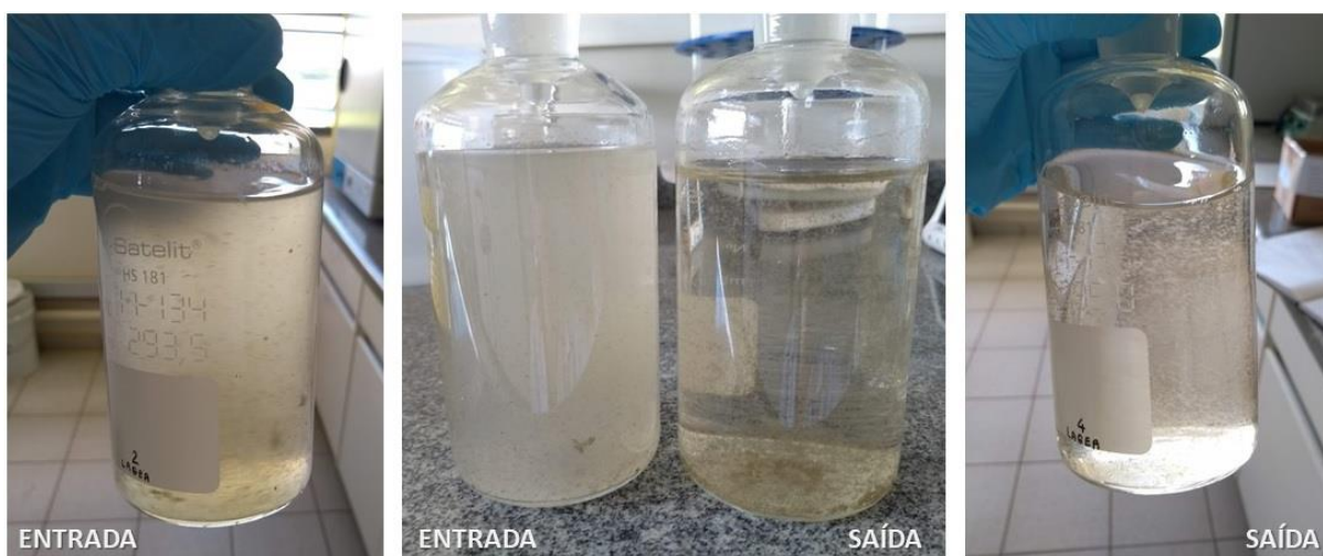
Figura 27: Amostras de esgoto coletadas no ponto de captação do esgoto, amostras de entrada, e após etapas convencionais de tratamento da E.T.E, amostras de saída. Fonte: O autor (2018)
