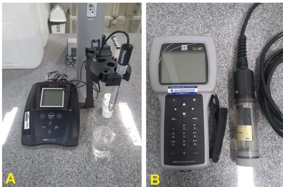
Figura 16: A- PHmetro da marca Thermo Scientific , modelo Orion Star A111 utilizado nas análises de pH. B- Multiparâmetros utilizado para leitura da C.E, equipamento da marca YSI, modelo 556 MPS. Fonte: O autor (2019).
