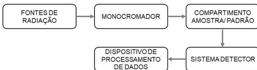
Figura 7: Esquema dos componentes principais de um espectrofotômetro. Fonte: O autor (2018).
