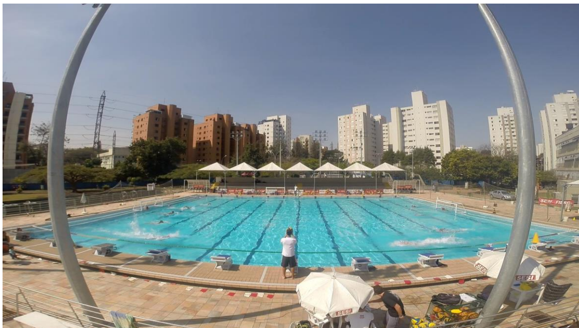
Figura 7. Enquadramento da câmera GoPro sem correção da distorção radial.
