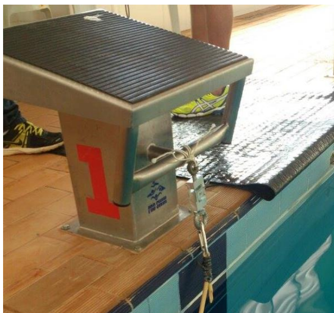
Figura 2. Fixação da célula de carga no bloco de partida.
