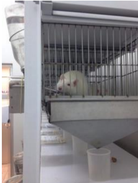
Figura 4: Gaiola metabólica para coleta da urina de 24 horas dos animais.
