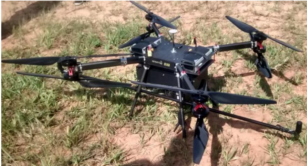
Figura 10 - SVL embarcado em plataforma VANT.
