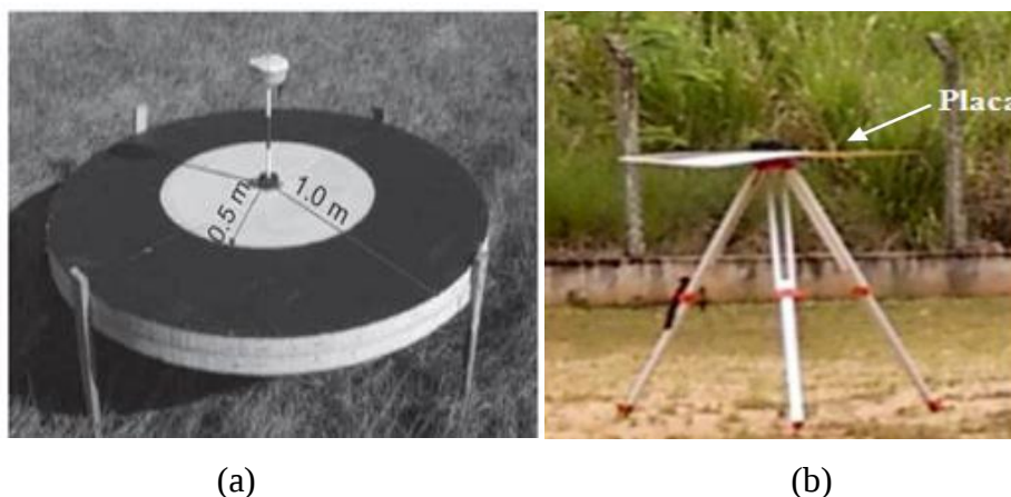
Figura 8 - Alvos para controle externo de nuvem de pontos LASER: (a) modelo de alvo circular, (b) modelo de alvo plano sobre tripé.
