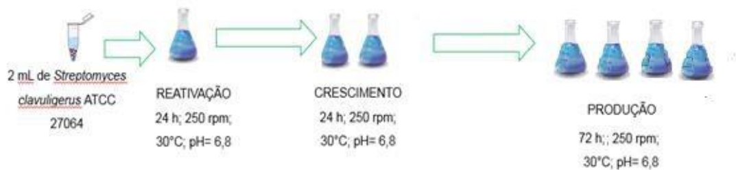
Figura 15. Ilustração do experimento para análise de produção de AC em diferentes configurações de frascos Erlenmeyers (arquivo próprio).
