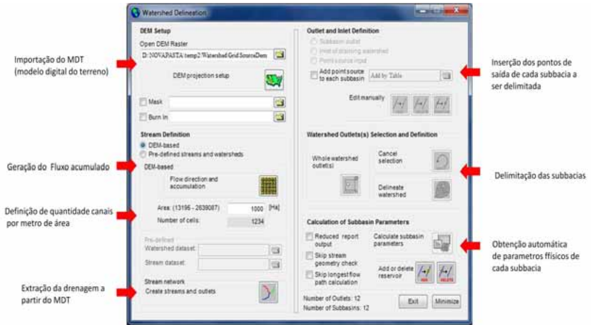
Figura 7 - Esquema representativo procedimento para delimitação de sub-bacias e obtenção de parâmetros morfométricos
