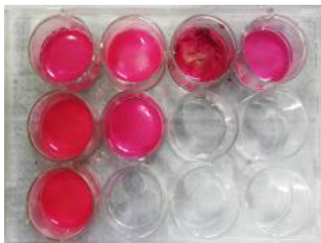
Figura A1- Placa de 12 poços com os eluídos dos cimentos
