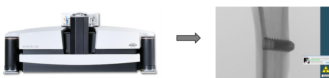
Figura 13 – Escaneamento das peças através do aparelho e software SkyScan.
