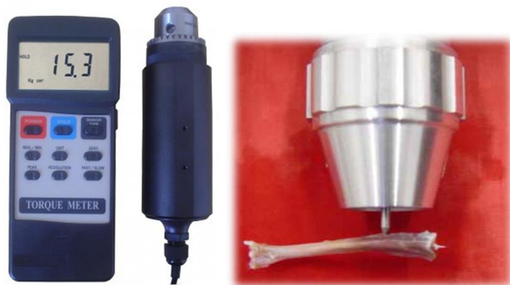
Figura 12 - Torquímetro Digital e monta implante utilizados para análise biomecânica.
