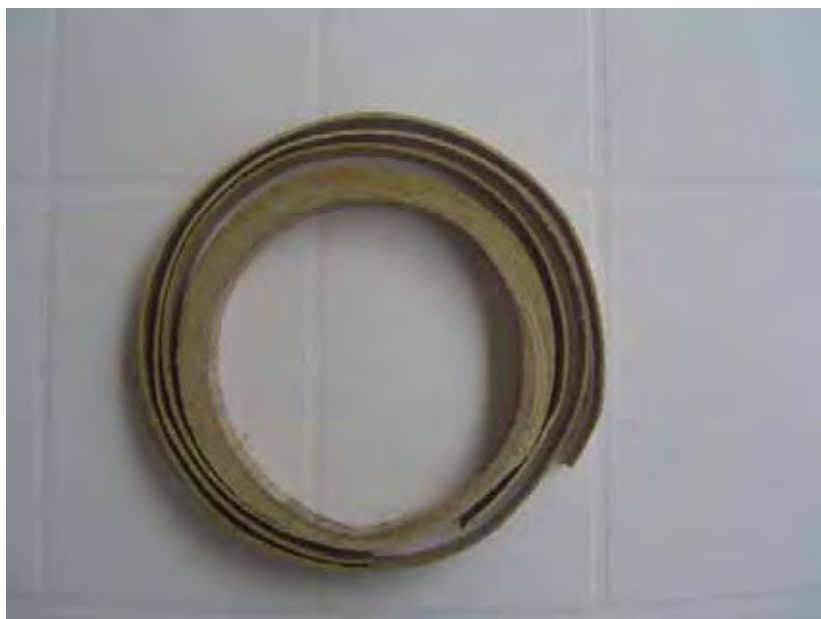
Figura 4.18- Colmo verde e lâmina produzidos em torno sem centros interno
