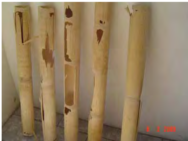
Figura 4.5. Sobras de laminação: rolo resto.
