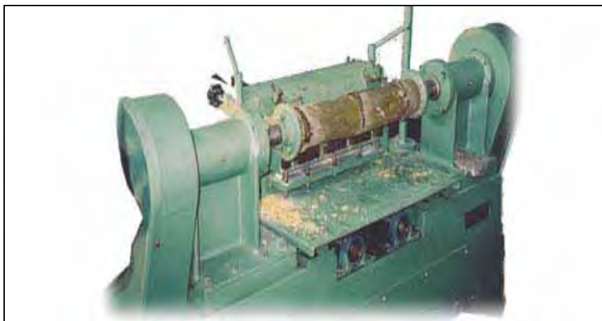
Figura 2.23- Torno com garras para laminar bambu.Fonte: FRDI.
