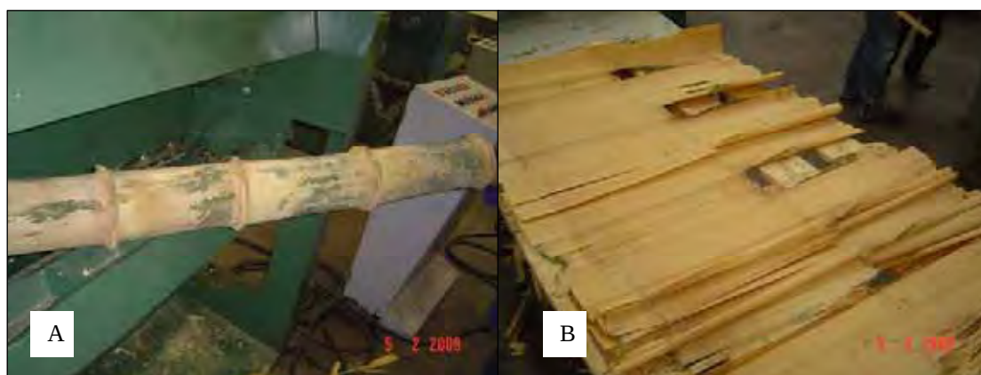
Figura 4.3 -Alimentação do colmo (A), Lâminas imediatamente após processo (B).
