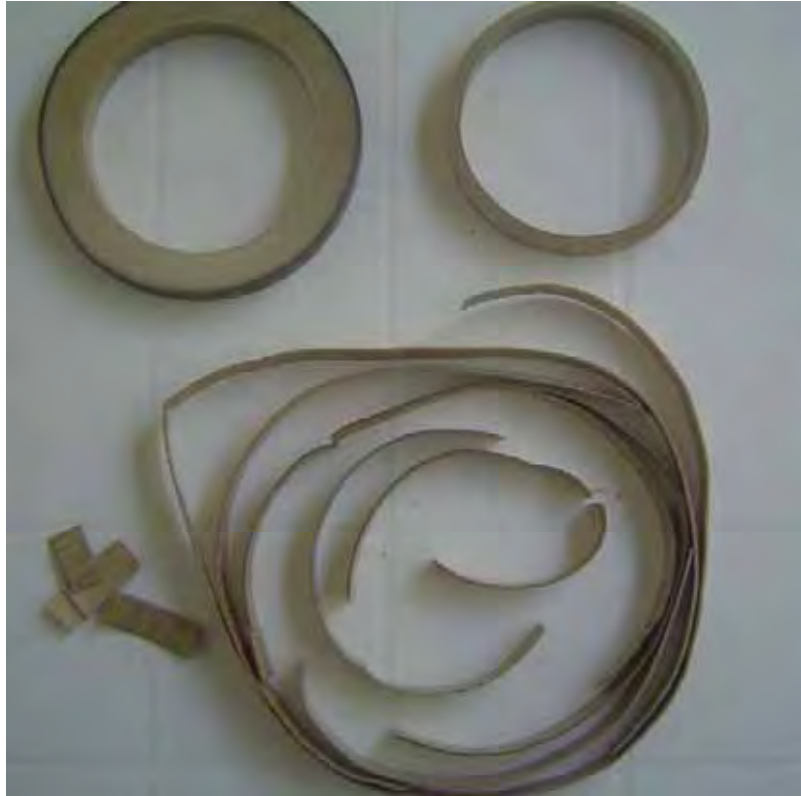
Figura 4.21- Colmo, rolo resto e lâminas de bambu tratado laminado seco (12% de umidade).
