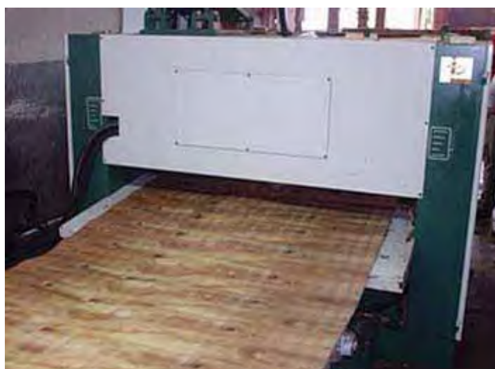
Figura 2.21- Torno laminador industrial sem centros. Fonte: OMECO.
