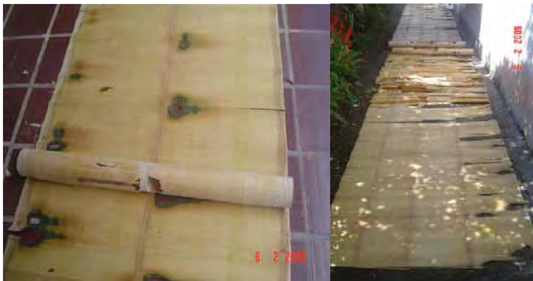
Figura 4.4 Lâminas sendo secas ao natural.
