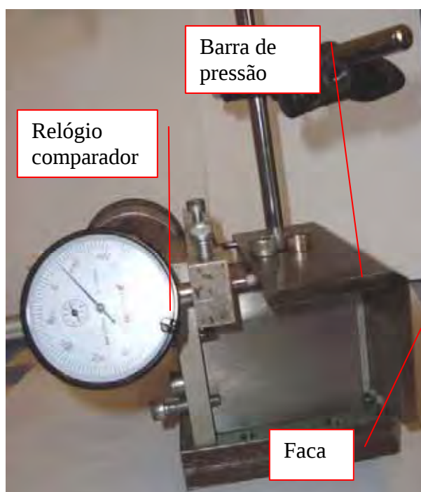
Figura 3.9 - Verificação do ajuste da abertura horizontal.
