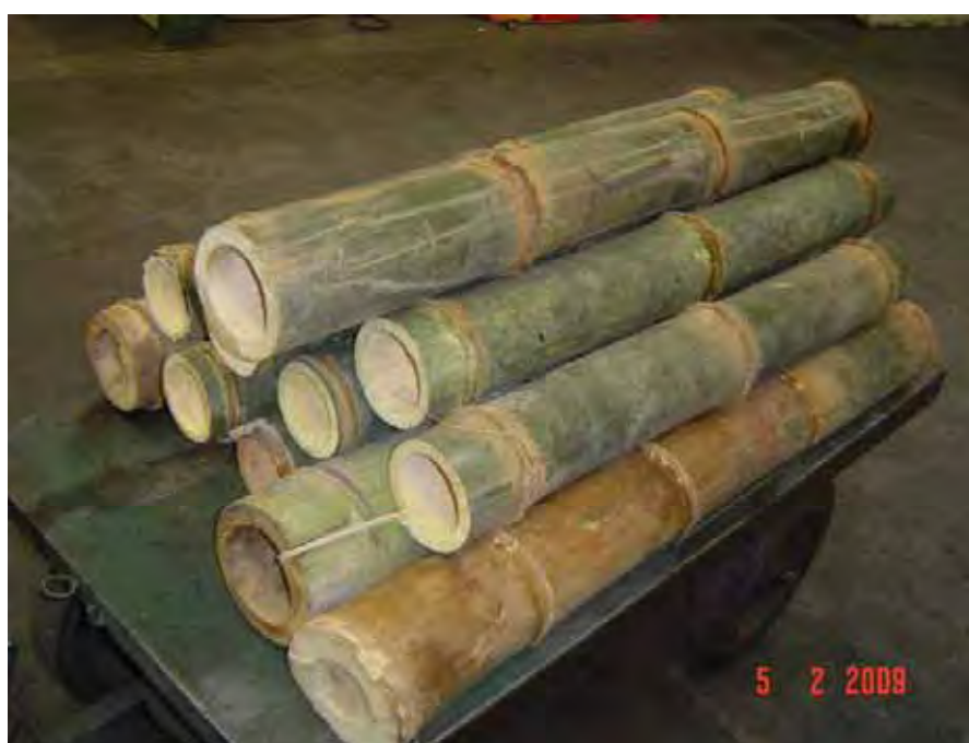
Figura 3.2 - Corpos de prova para experimentação em laminador sem centros.
