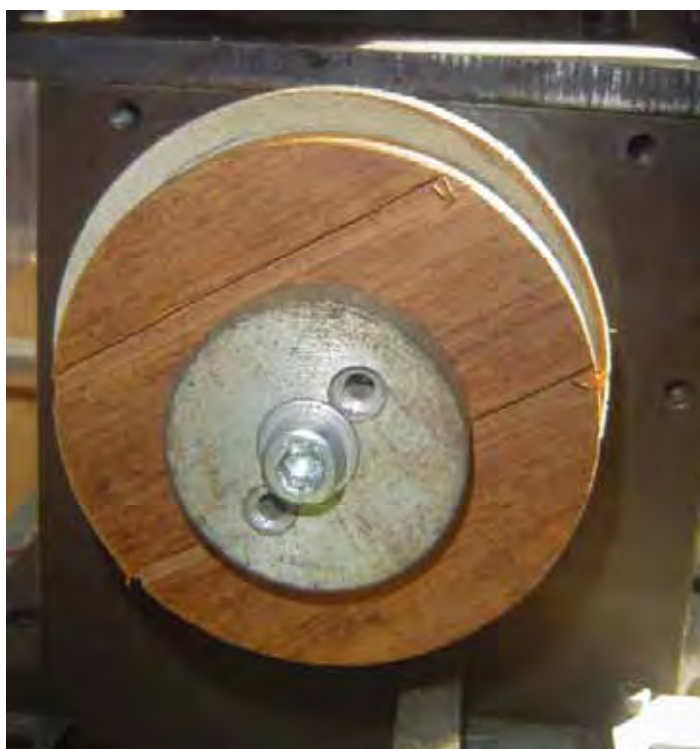
Figura 4.14- Rolo resto da laminação com centros e faca flutuante.
