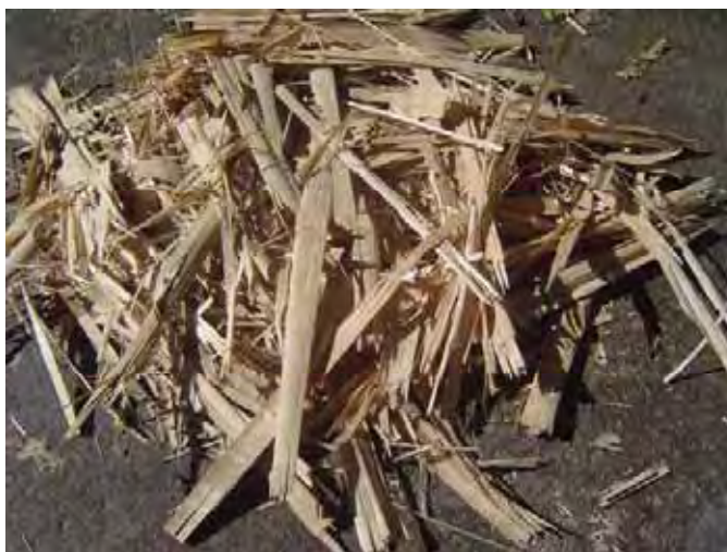
Figura 4.7. Aparas resultantes da laminação sem centros em torno industrial.
