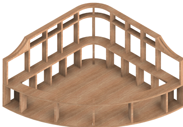
Figura 09: Estrutura interna da poltrona
