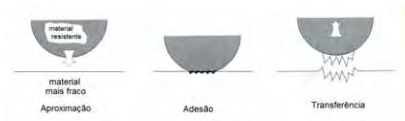
Figura 2.9 - Processo de transferência de metal devido à adesão
