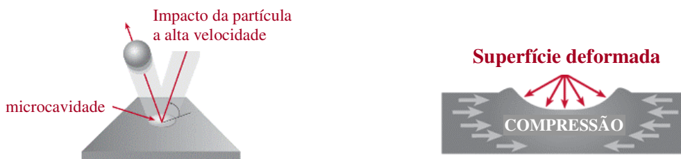
Figura 2.8 - Efeito do shot peening na superfície metálica (METAL IMPROVEMENT COMPANY, 2007).
