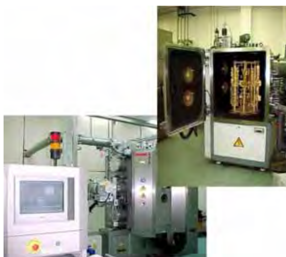
Figura 3.1- Sistemas de deposição PVD da Brasimet: Magnetron Sputtering (Esquerda) e Arco-Voltaico (Direita) (Cortesia da Brasimet)
