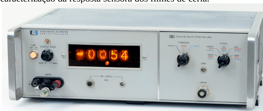
Figura 20 - Equipamento para tomada das medidas elétricas com sonda de duas pontas utilizado na caracterização da resposta sensora dos filmes de céria.
