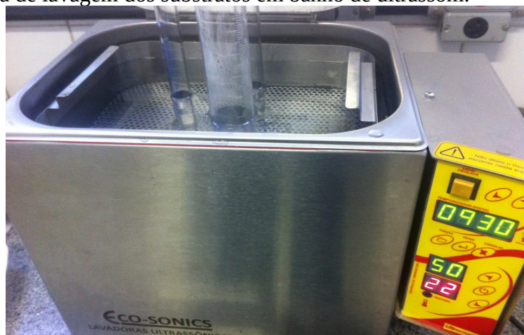
Figura 17 - Etapa de lavagem dos substratos em banho de ultrassom.
