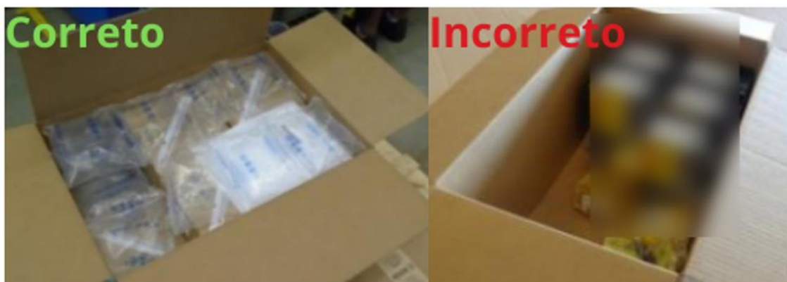
Figura 10: Preenchimento das caixas
