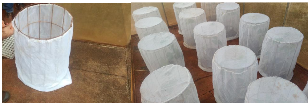
Figura 3. Gaiola (armação de ferro + tecido voile ) utilizada no teste de antixenose para oviposição, sem chance de escolha.
