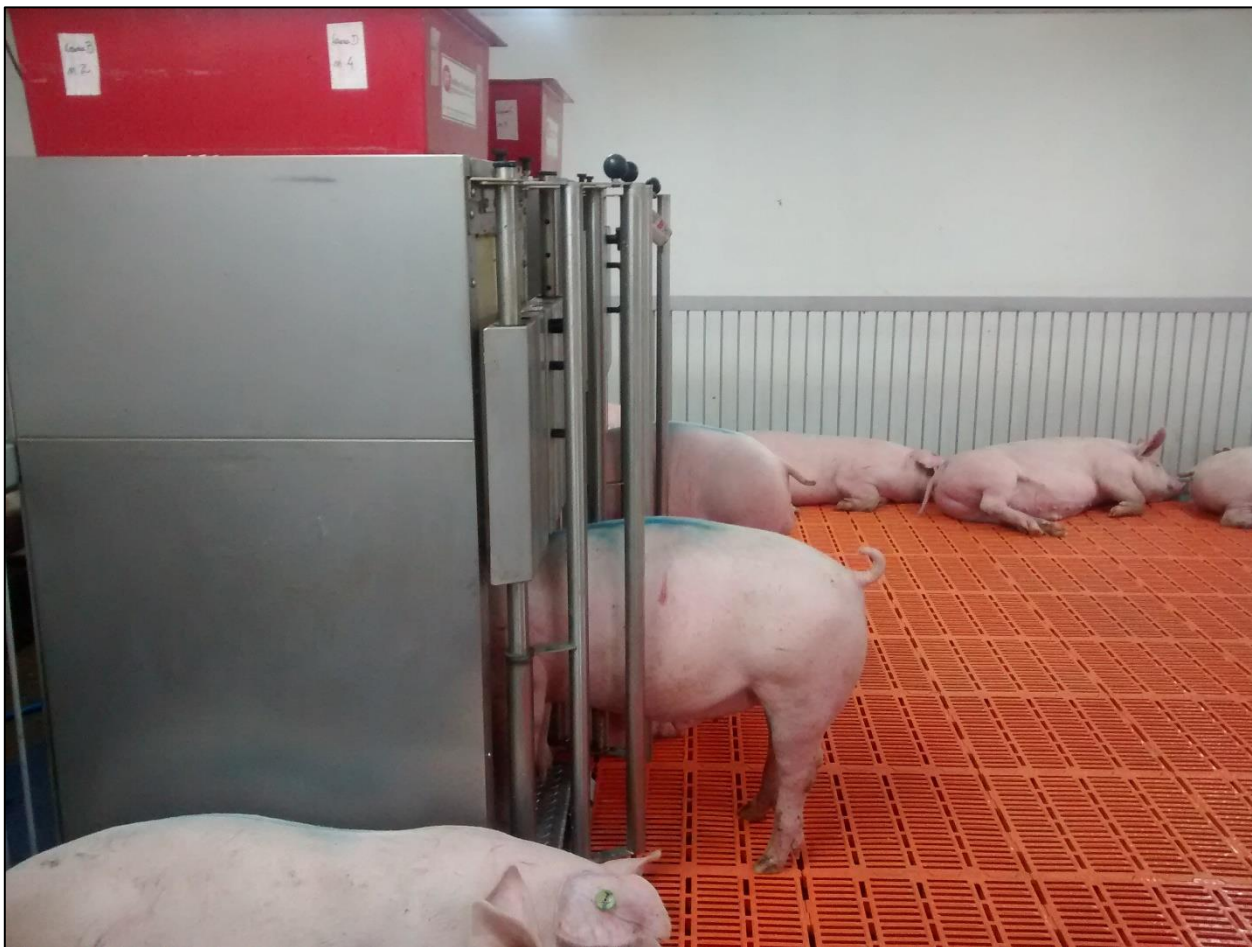
Figura 4.1. Ilustração da baia coletiva dotada de dois alimentadores automáticos.
