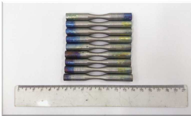
Figura 17 - Corpo de prova de fadiga
