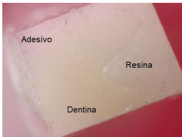
Figura 14 - Imagem de estereomicroscopia de palito com fratura mista pertencente ao grupo SB
