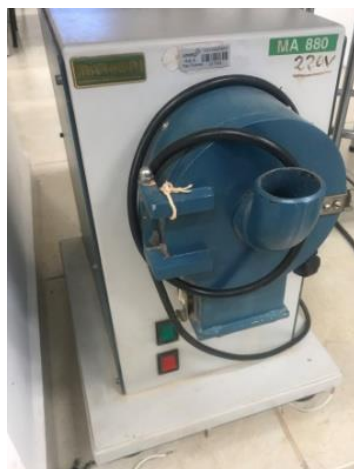
Figura 8 – Moinho de facas para moagem.
