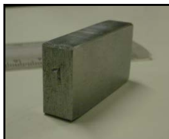
Figura 4.23 – Corpo de prova para ensaio de micrografia.
