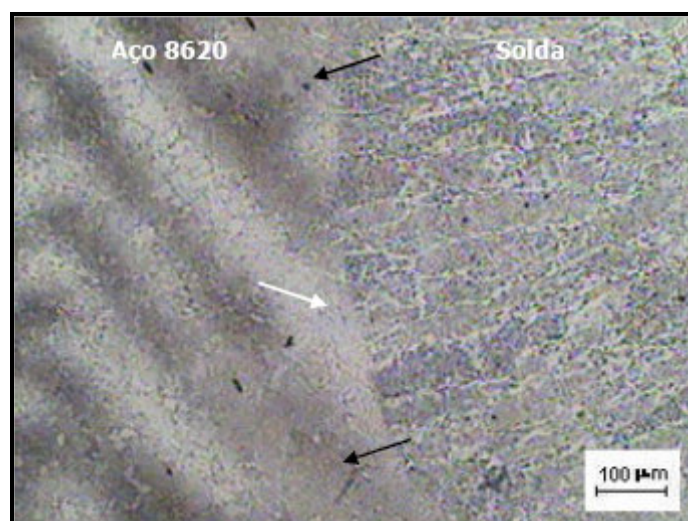
Figura 5.14 – Fotomicrografia B de corpo de prova soldado com temperatura de pré-aquecimento de 220°C e com tecimento ZIGZAG.
