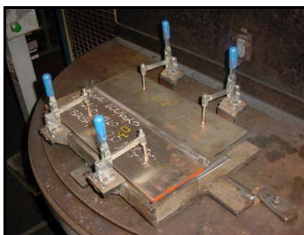
Figura 4.17 – Corpo de prova posicionado no dispositivo de soldagem.
