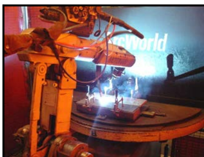
Figura 4.12 – Operação de soldagem dos corpos de prova.
