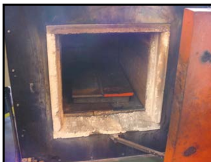
Figura 4.16 – Corpo de prova pronto para ser pré-aquecido.
