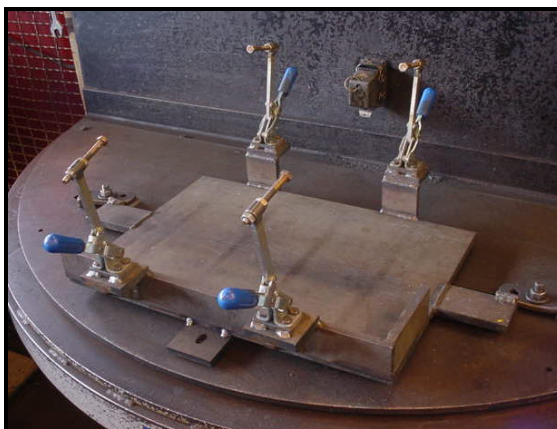
Figura 4.5 – Dispositivo de Soldagem.
