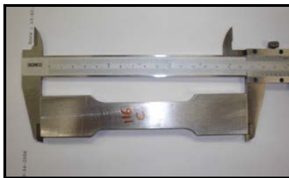
Figura 4.22 – Corpo de prova para ensaio de tração.
