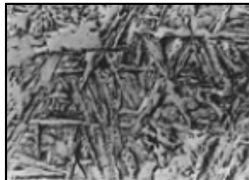
Figura 3.24 – Exemplo de microestrutura composta de ferrita acicular (Vishnu, 1993).
