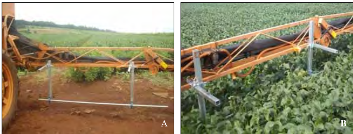
Figura 8. Canopy opener acoplado ao pulverizador de arrasto Advance Vortex 2000 (A) e aplicação do fungicida na parcela (B). Botucatu-SP, 2012.
