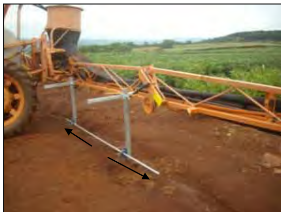
Figura 4. Dispositivo CO montado e anexado à barra de pulverização. Flechas indicam a possibilidade de movimentação da barra tubular. Botucatu-SP, 2012.
