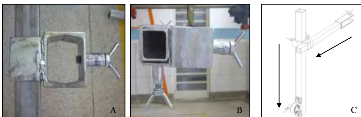
Figura 5. Detalhes das abraçadeiras com porca e parafuso (A e B) e abraçadeira servindo como elo entre suporte vertical e barra horizontal. Botucatu-SP, 2012.
