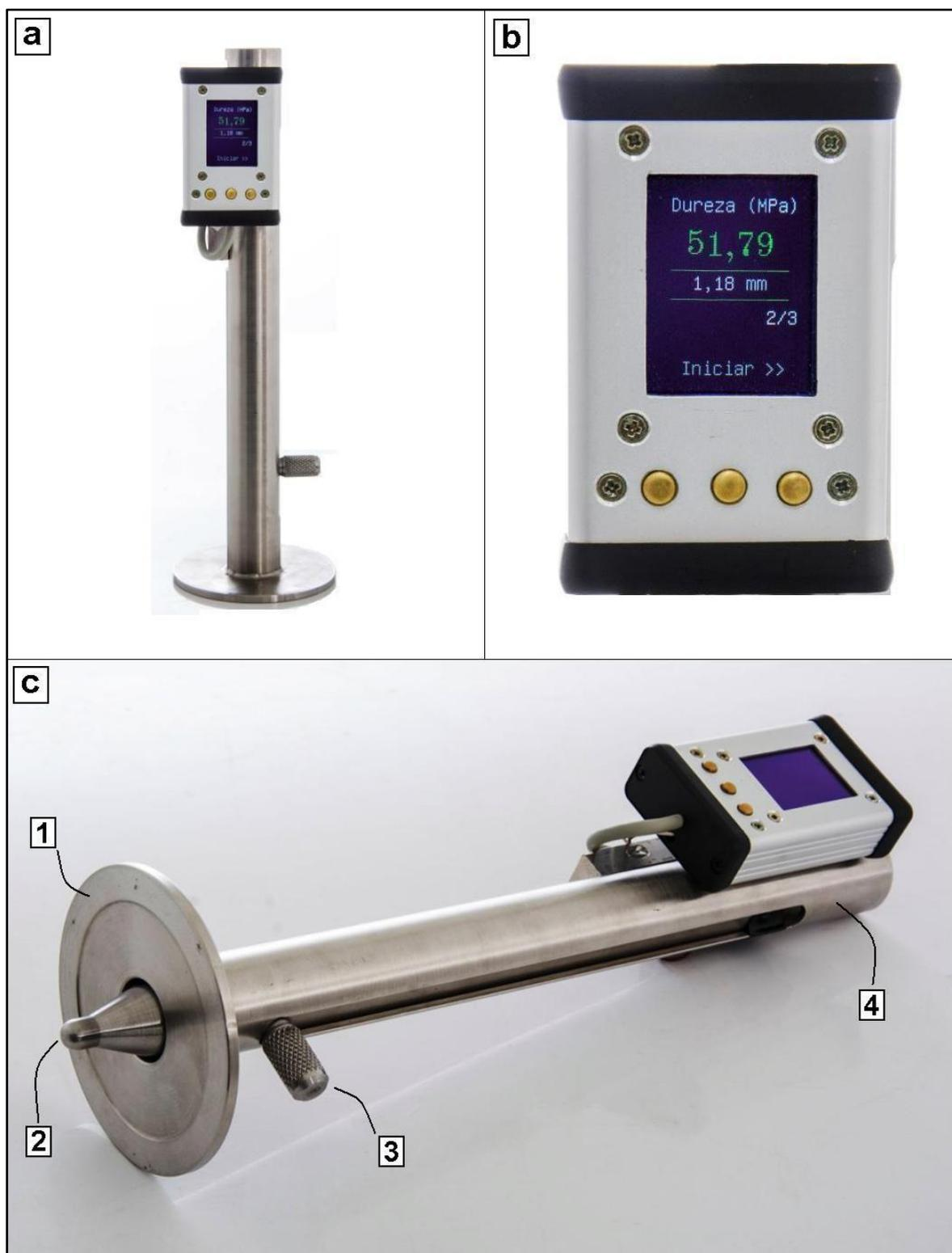
Figura 11 – Durômetro Portátil para Madeiras: a) equipamento na posição vertical, b) detalhe do painel eletrônico, c1) flange, c2) endentador, c3) manípulo e c4) suporte principal
