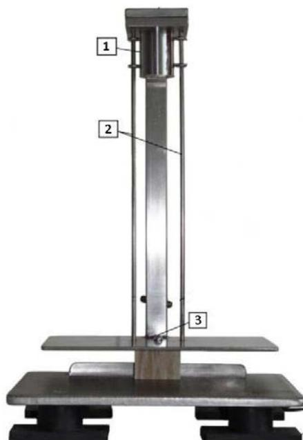
Figura 9 - Protótipo de equipamento para medição de dureza dinâmica. 1) massa de impacto, 2) guias e 3) esfera metálica.
