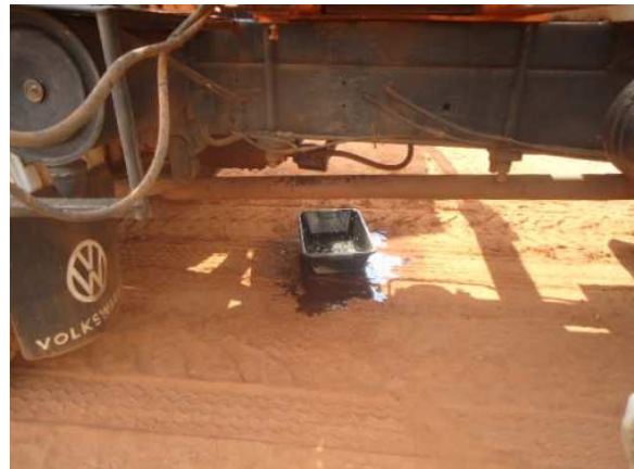
Figura 8 – Vazamento de óleo no solo
