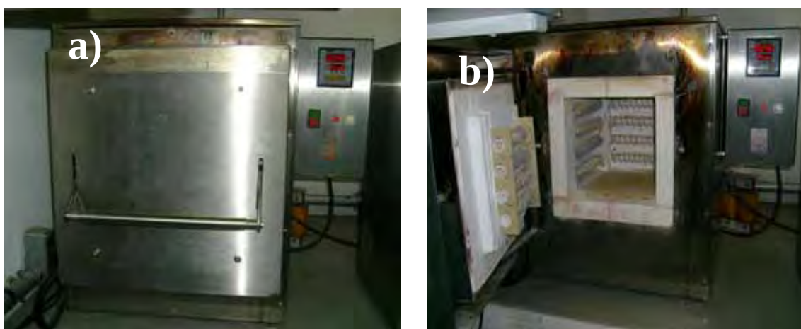
Figura 13: Forno utilizado para a calcinação do precursor do K 2 Sr 2 (Ni x Nb 5-x )O 15-δ . a) Forno fechado e b) Forno aberto.
