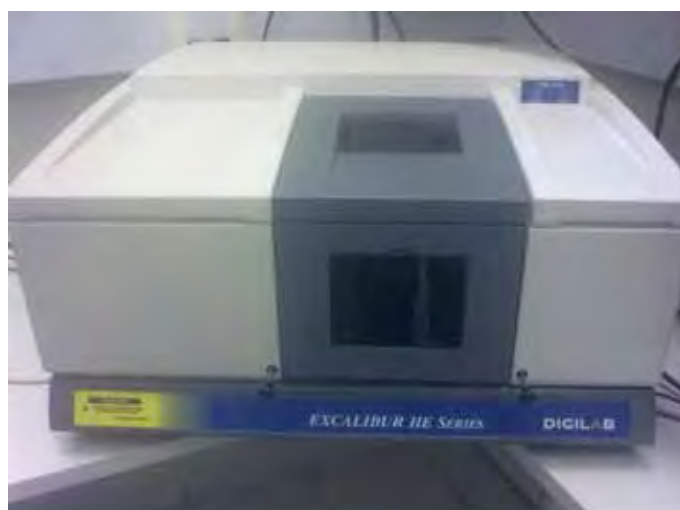
Figura 18: Espectrofotômetro utilizado para medidas de absorção na região do infravermelho dos pós dos sistemas \text{KSr}_2(\text{Ni}_x\text{Nb}_{5-x})\text{O}_{15-\delta} , onde x=0; 0,25; 0,5; 0,75 e 1 .
