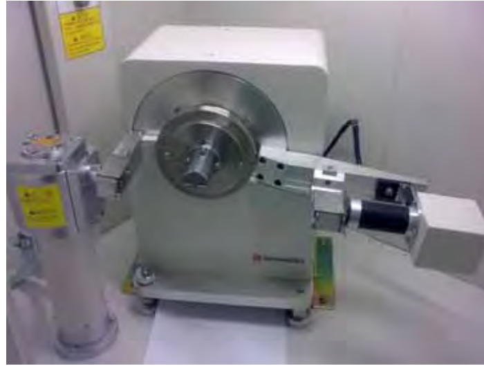
Figura 19: Difratômetro utilizado para medidas de difração de raios X dos pós dos sistemas \text{KSr}_2(\text{Ni}_x\text{Nb}_{5-x})\text{O}_{15-\delta} , onde x=0; 0,25; 0,5; 0,75 e 1,0 .
