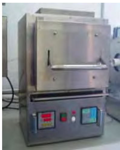
Figura 16: Forno tipo câmara (volume de 3 litros) da marca INTI utilizado para a calcinação do pó precursor do \text{KSr}_2(\text{Ni}_x\text{Nb}_{5-x})\text{O}_{15-\delta} , em diversas temperaturas e tempos de tratamento térmico.
