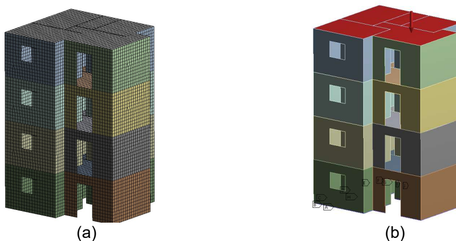
Figura 33 - Modelo numérico com interação de grupos de paredes com (a) malha discretizado e (b) carregamento da laje no quarto pavimento.
