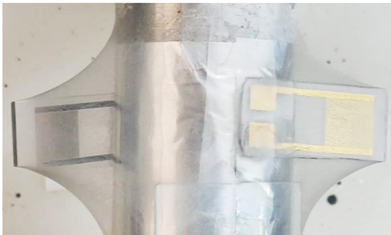
Figura 24. Nanofibras eletrofiadas sobre o IDE.
