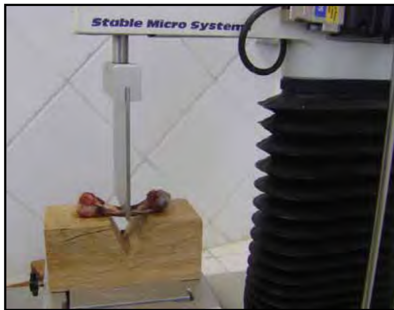
Figura 2. Fotografia da peça óssea no momento da execução da análise de resistência, com vão livre de 3cm.
