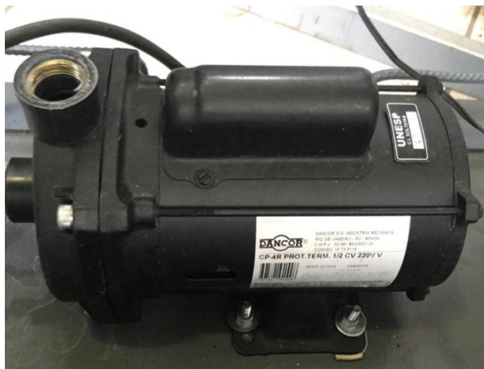
Figura 14 - Bomba de recirculação da primeira etapa
