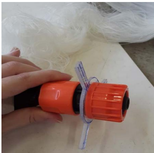
Figura 11 - Peça suporte de acrílico instalada na conexão da extremidade do feixe de membranas
