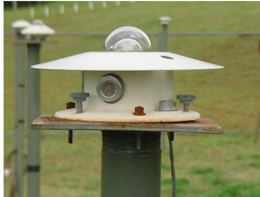
Figura 1 - Piranômetro Eppley-PSP em superfície horizontal
