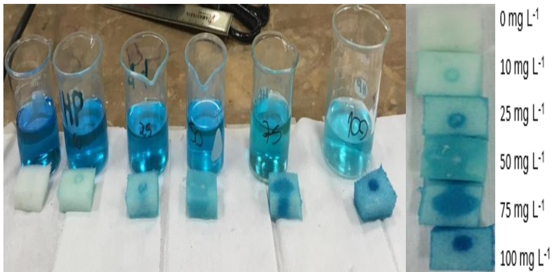
Figura 18 - A) Demonstração da diminuição da coloração da solução de A.M em função do aumento da concentração de SDS. B) Aumento da intensidade da coloração na EPU devido ao aumento da adsorção do par iônico, proporcional à concentração de SDS em solução.
