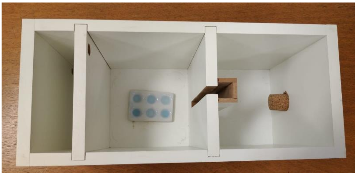
Figura 15 - Câmara de madeira utilizada durante os procedimentos de análise por imagem digital.
