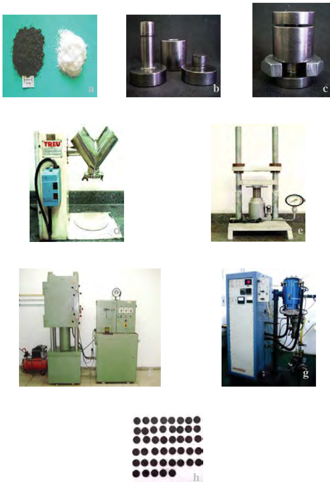
Figura 2 – Procedimento de confecção das amostras: a) pó de titânio e uréia em grânulos; b-c) matriz idealizada para confecção das amostras; d) misturador Y; e) prensa uniaxial; f) prensa isostática; g) forno à vácuo; h) amostras de titânio.
