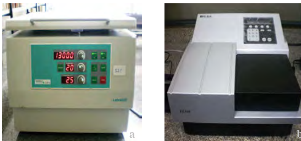
Figura 11 - Quantificação de formações nodulares e matriz mineralizada. a) centrífuga Labnet– HERMLE Z 300K, NJ, USA; b) espectrofotômetro (para leitura das absorvâncias no comprimento de onda de 405 nm).
