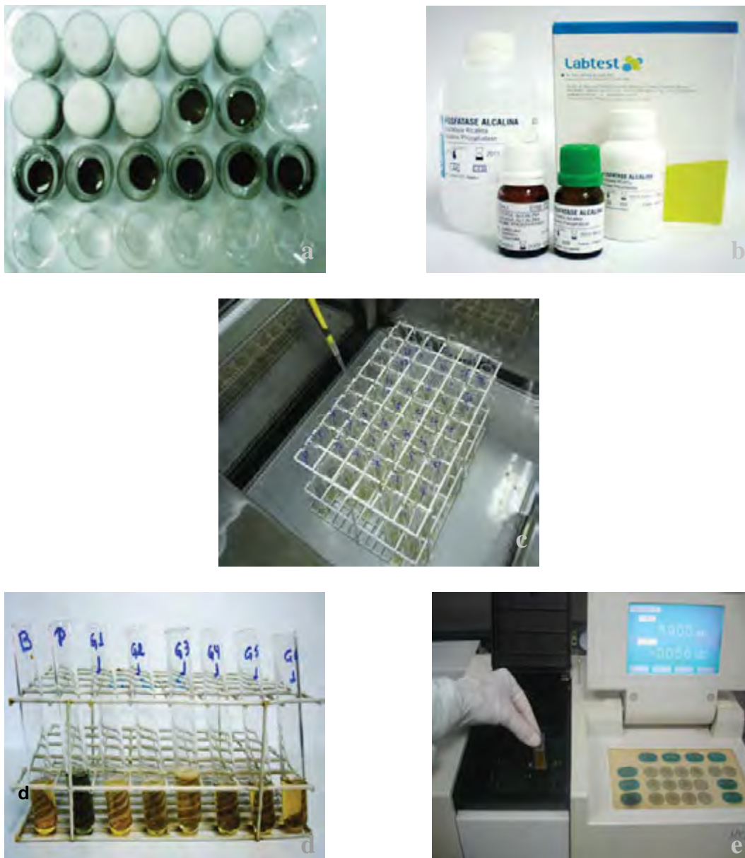
Figura 9 - Atividade de fosfatase alcalina. a) lisados celulares; b) kit comercial Labtest; c) tubos de ensaio com reagentes recebendo alíquotas das amostras; d) tubos de ensaio contendo os reagentes e as alíquotas das amostras; e) espectrofotômetro para leitura das absorbâncias no comprimento de onda de 590 nm.
