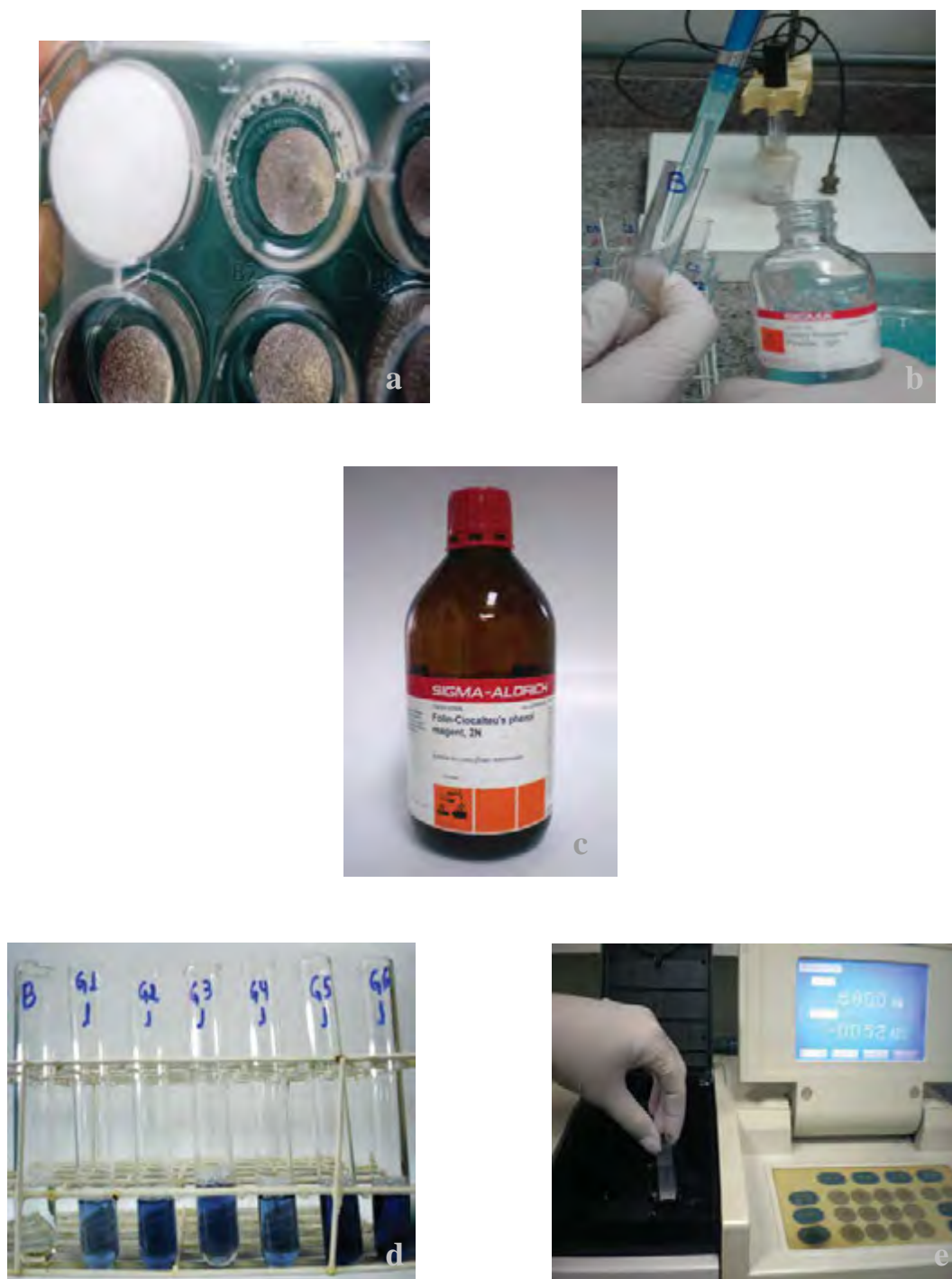
Figura 8 - Conteúdo de proteína total. a) poços preenchidos com lauril sulfato de sódio; b) tubos de ensaio recebendo reagente de Lowry; c) reagente de Folin e Ciocalteu; d) tubos de ensaio contendo os reagentes e as alíquotas das amostras; e) espectrofotômetro (Shimadzu UV-1203).
