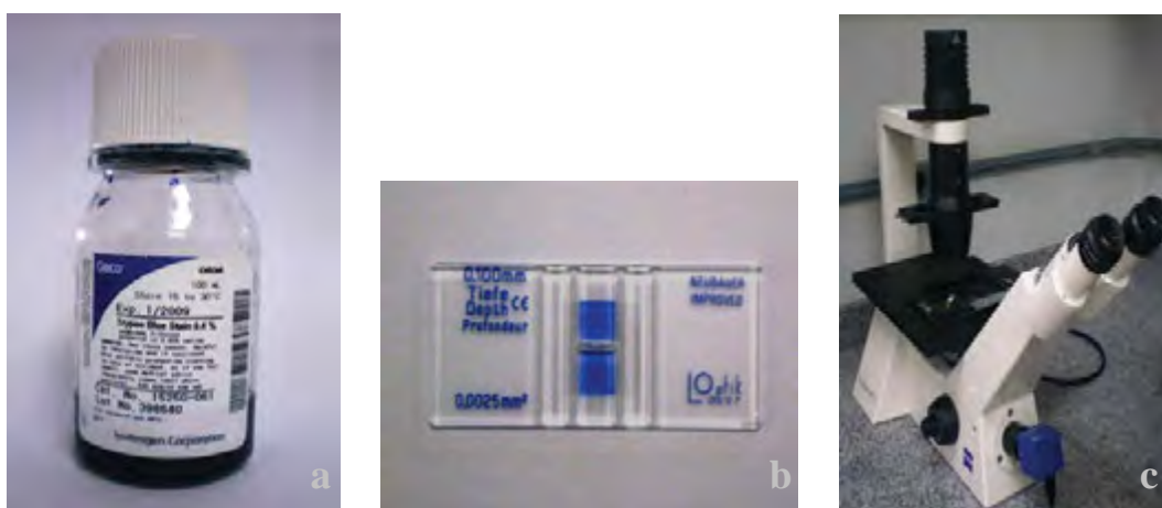
Figura 6 - Adesão celular. a) corante azul de Trypan 0,4%; b) câmara de Neubauer; c) microscópio usado para contagem das células na câmara de Neubauer.
