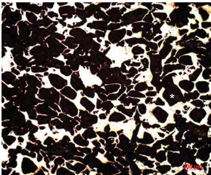
Figura 15 – Fotomicrografia de microscópio óptico da superfície interna das amostras do Grupo 2 (aumento de 50x), poros(*).
