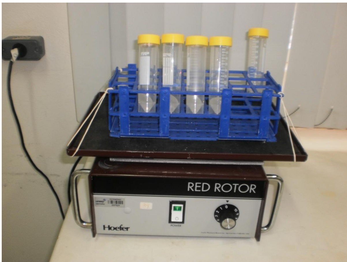
Figura 6: Tubos Falcon com membranas P 81 em agitação
