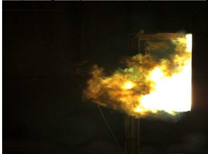
Figura 6 – Jato de plasma gerado por condutores dispostos na configuração VCBB
