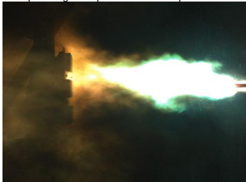
Figura 5 – Jato de plasma gerado por condutores dispostos na configuração HOA
