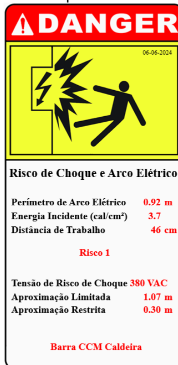
Figura 10 – Exemplo de etiqueta de sinalização de arco elétrico
