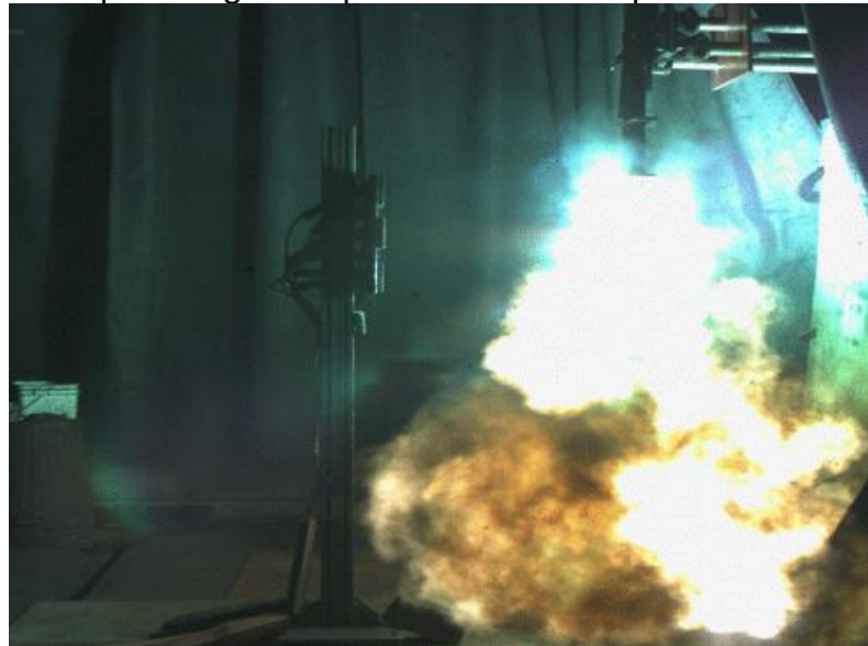
Figura 7 – Jato de plasma gerado por condutores dispostos na configuração VOA
