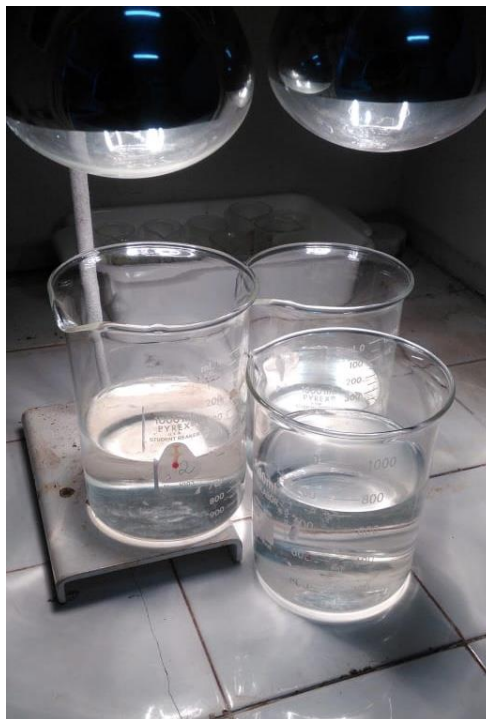
Figura 12. Béqueres com água no processo de evaporação pelas lâmpadas infravermelho.
