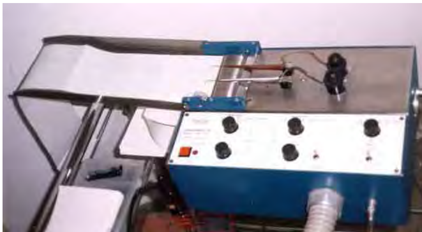
FIGURA 1 – Aparelho utilizado para a realização da rinomanometria anterior ativa. Rinomanômetro RM – 302 da marca Berger.
