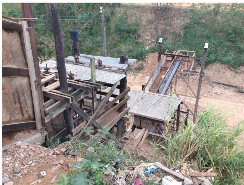
Figura 18 – Estrutura utilizada para o processamento dos Resíduos de Construção e Demolição no Parque Santa Luzia.
