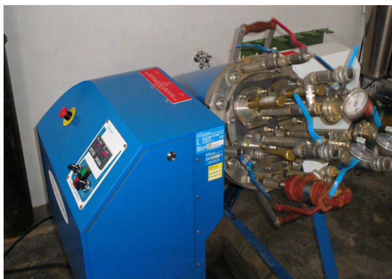
Figura 3.2 – Digestor Regmed usado no processo de pré-hidrolise e polpação
